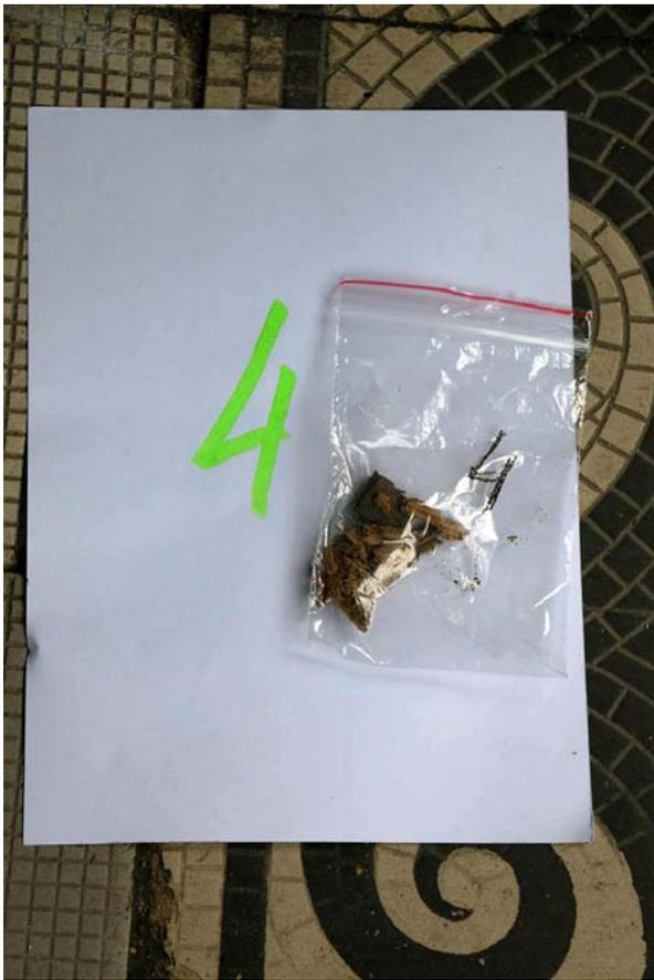
Фото 110. Образец №4. Отщеп древесины верхней правой части наружной дверной коробки парадной №1 с историческими окрасочными слоями.
