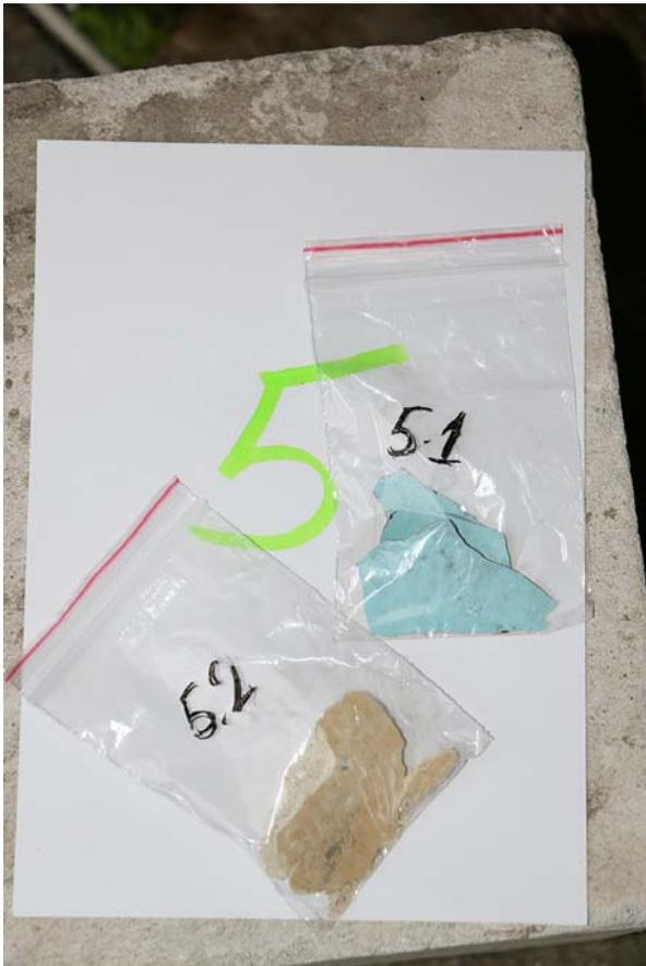
Фото 112. Образцы №5.1 и №5.2. Образец №5.1 (окрасочные слои) и образец №5.2 (штукатурные слои) верхней правой части стены парадной №1
