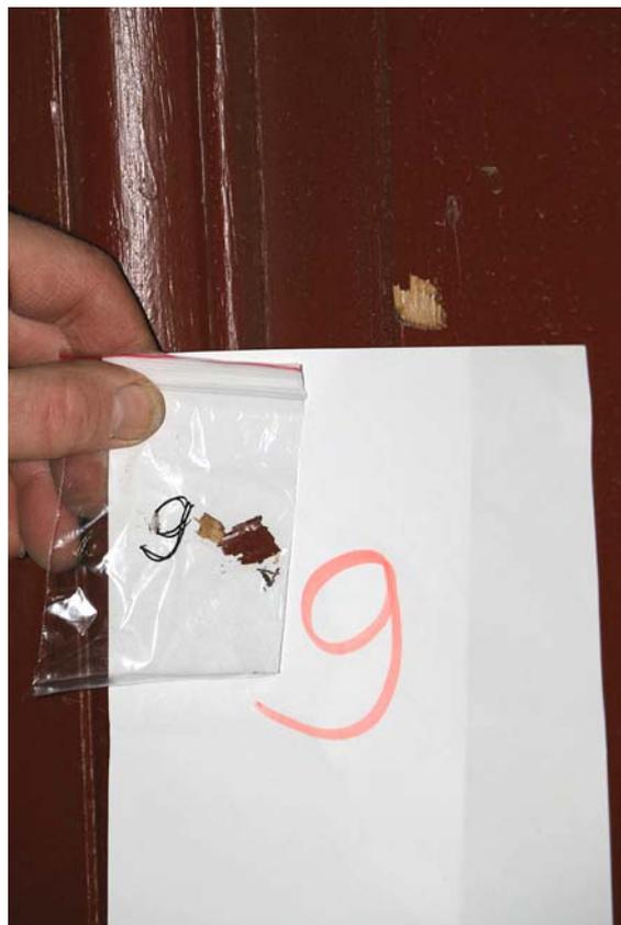
Фото 122. Образец №9. Отщеп древесины с окрасочными слоями с правой боковой двери тамбура парадной №2 рядом с местом отбора образца.
