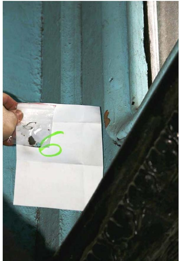
Фото 113. Образец №6. Окрасочные слои нижней части наружной фигурной фрамуги парадной №1 (внутри тамбура) рядом с местом отбора образца.
