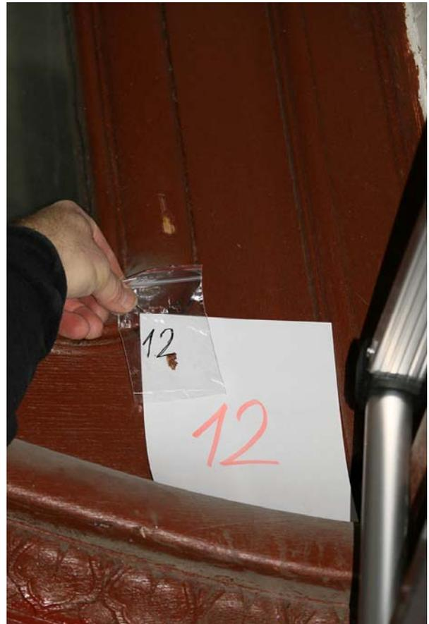
Фото 129. Образец №12. Отщеп с окрасочными слоями нижней части внутренней фигурной фрамуги парадной №2 рядом с местом отбора образца.
