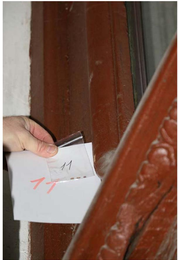
Фото 127. Образец №11. Окрасочные слои нижней части наружной фигурной фрамуги парадной №2 рядом с местом отбора образца.
