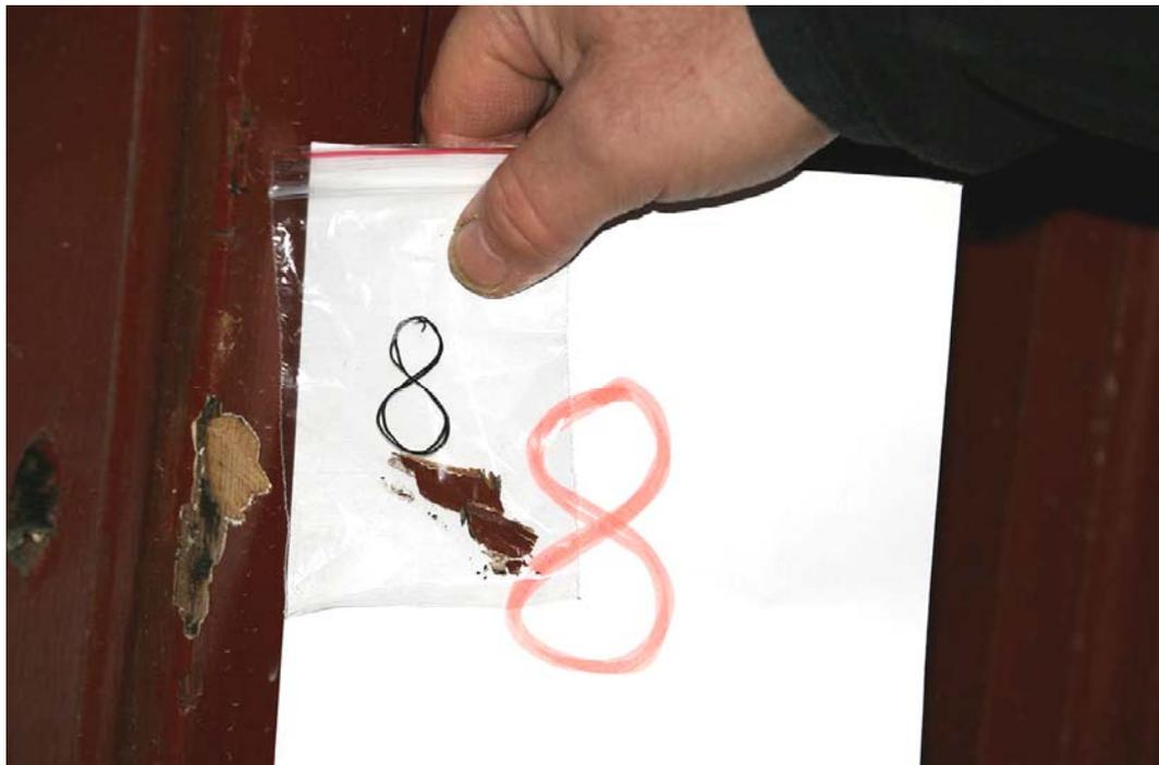
Фото 120. Образец №8. Отщеп древесины с окрасочными слоями с левой боковой двери тамбура парадной №2 рядом с местом отбора образца.
