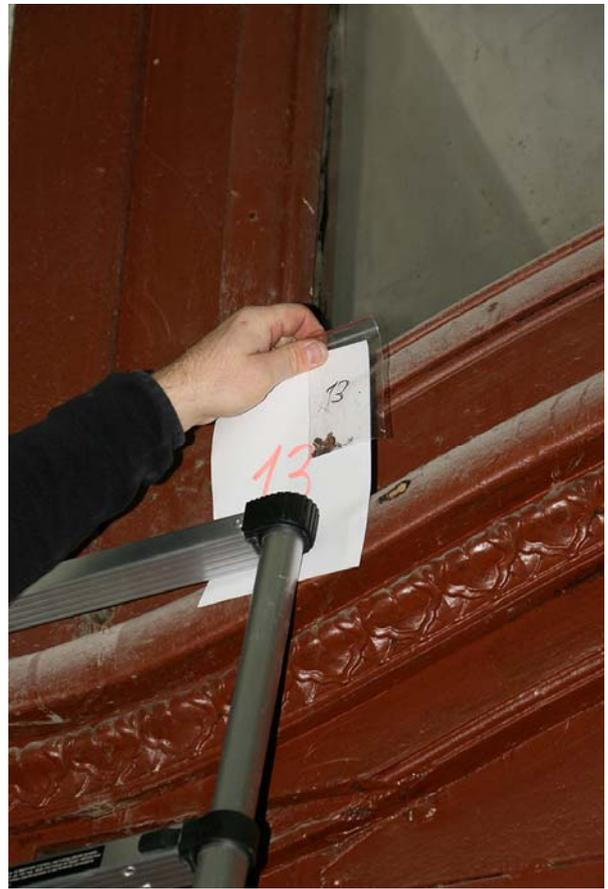
Фото 131. Образец №13. Отщеп с окрасочными слоями нижней части внутренней фигурной фрамуги парадной №2 (внутри парадной).
